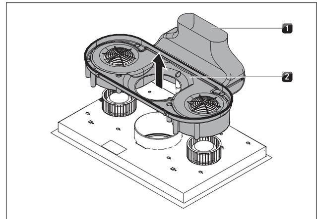
Abb. 6.28 Luftführungsgehäuse abnehmen
