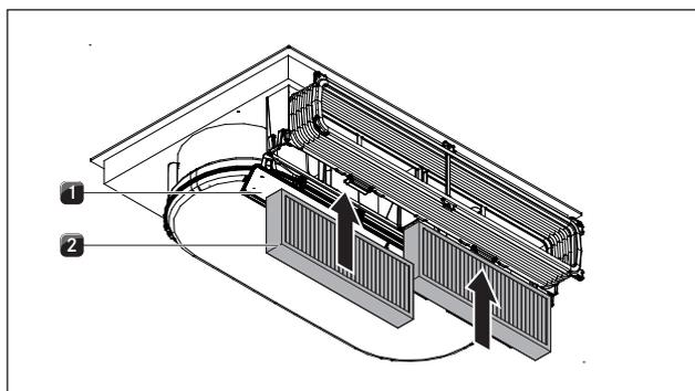
Abb. 6.17 Aktivkohlefilter einsetzen
