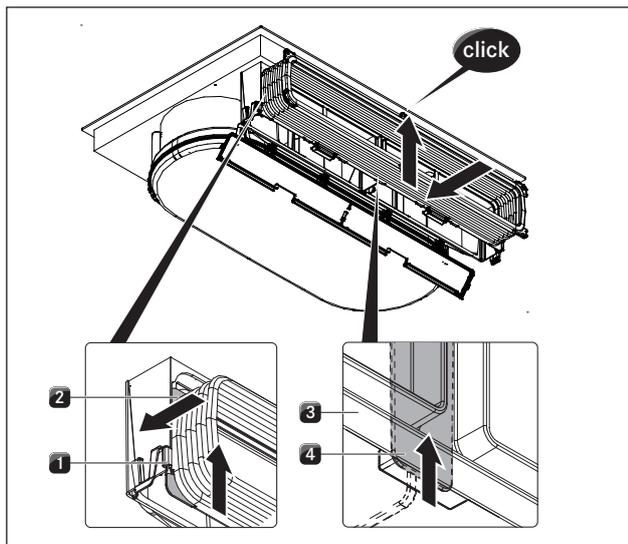
Abb. 6.16 Rahmen des Flexkanals einhängen
