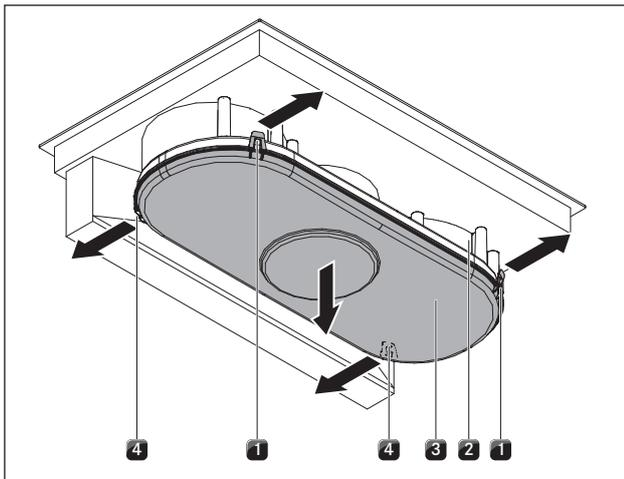
Abb. 8.3 Luftführungsgehäuse öffnen
