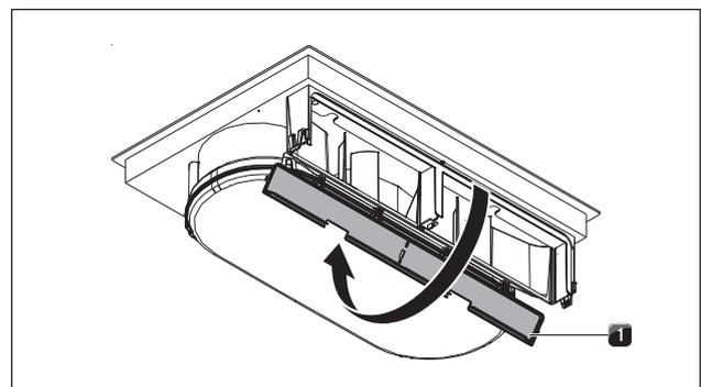
Abb. 6.15 Gehäusedeckel öffnen
