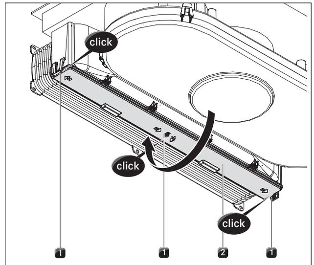
Abb. 8.10 Aktivkohlefiltergehäusedeckel schließen
