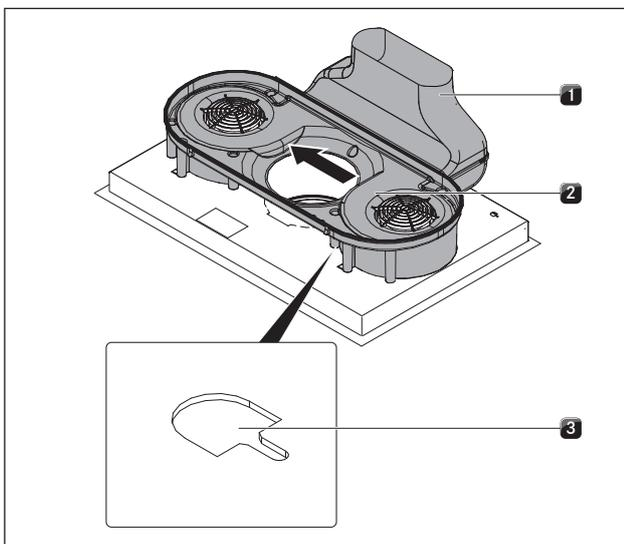
Abb. 6.27 Luftführungsgehäuse verschieben
