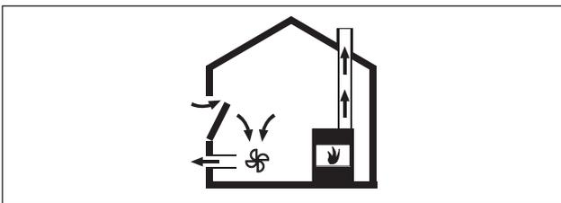
Abb. 6.20 Abluftmontage-korrekt
