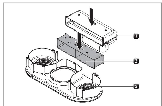
Abb. 6.30 Abluftkanalverlängerung einsetzen
