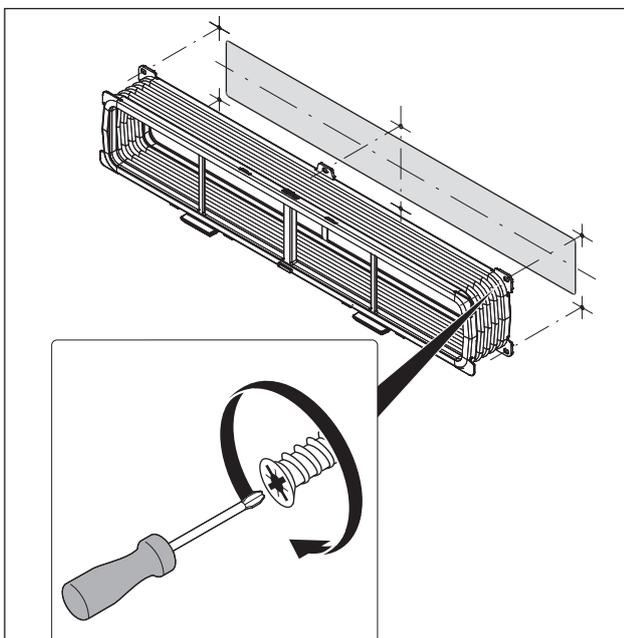
Abb. 6.13 Flexkanal mit 6 EURO-Schrauben 6,3 x 10 mm
