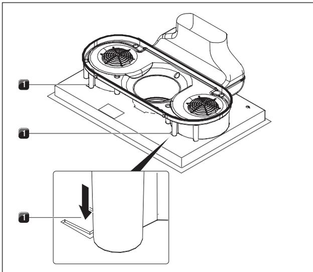
Abb. 6.26 Lagesicherung entriegeln
