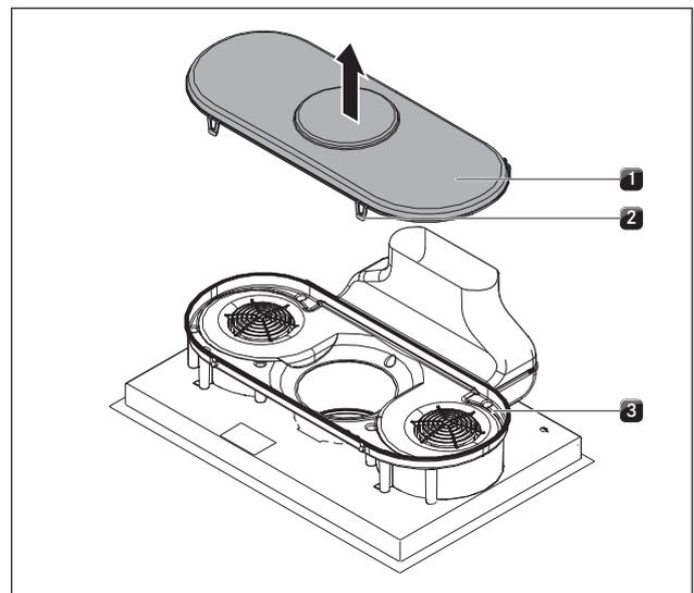
Abb. 6.25 Gehäuseboden abnehmen
