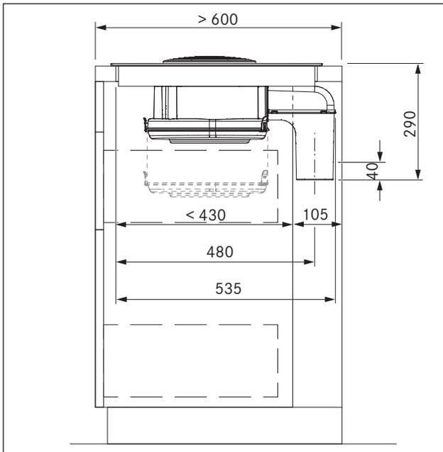
Abb. 6.23 Einbaumaße bei Abluft, Arbeitsplattentiefe 600 mm
