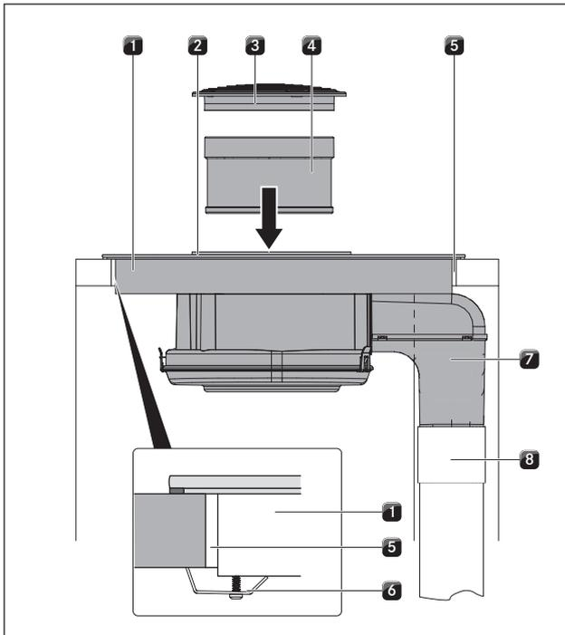
Abb. 6.35 Abluftkanal anschließen
