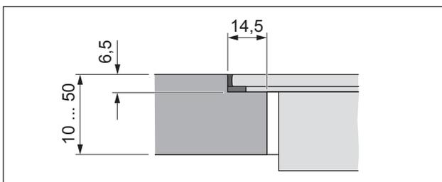
Abb. 6.3 Falzmaß für flächenbündige Montage
