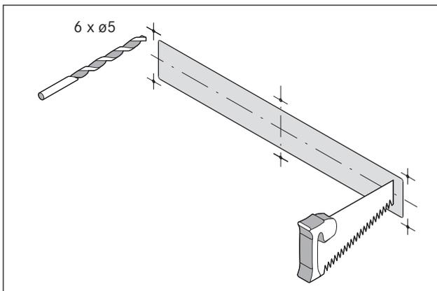
Abb. 6.12 Ausschnitt und Anschlussbohrungen
