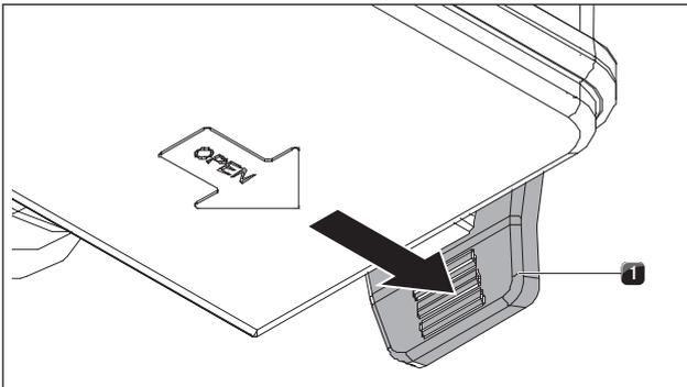
Abb. 8.7 Äußere Verriegelungen öffnen
