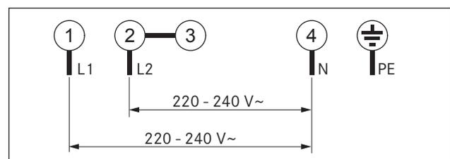
Abb. 6.37 Anschlussschema 2-Phasenanschluss
