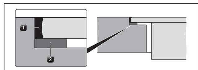
Abb. 6.7 Dichtungsband bei flächenbündiger Montage
