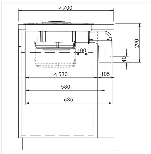
Abb. 6.24 Einbaumaße bei Abluft, Arbeitsplattentiefe ab 700 mm
