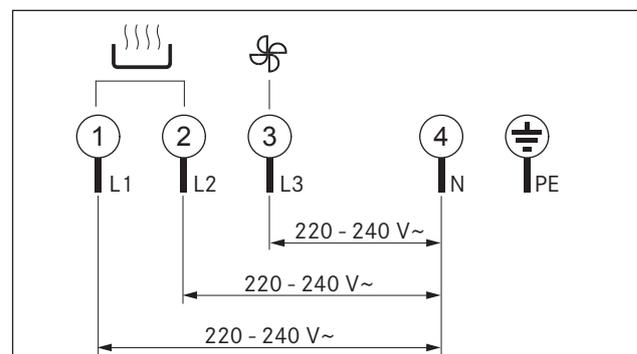
Abb. 6.36 Anschlussschema 3-Phasenanschluss
