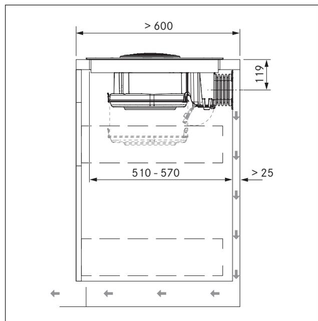
Abb. 6.11 Einbaumaße bei Umluft, Arbeitsplattentiefe 600 mm
