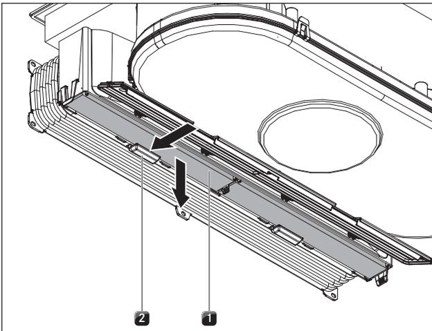
Abb. 8.8 Aktivkohlefilter entnehmen
