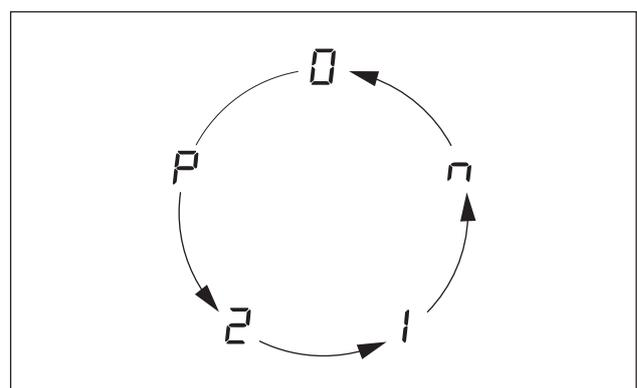
Abb. 7.2 Lüfterstufenabfolge  $\text{☐}$
