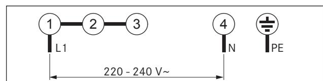
Abb. 6.38 Anschlussschema 1-Phasenanschluss
