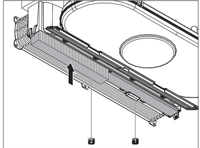
Abb. 8.9 Aktivkohlefilter einsetzen
